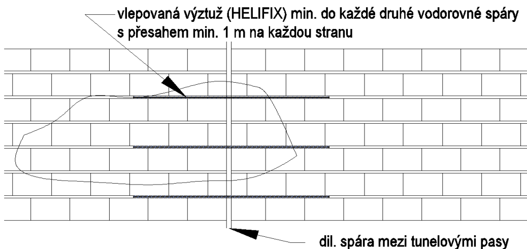
Obr. 4 Vlepovaná výztuž (např. HELIFIX)
